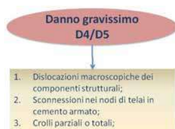
Figura 17. Caratteristiche danno gravissimo D4-D5.
