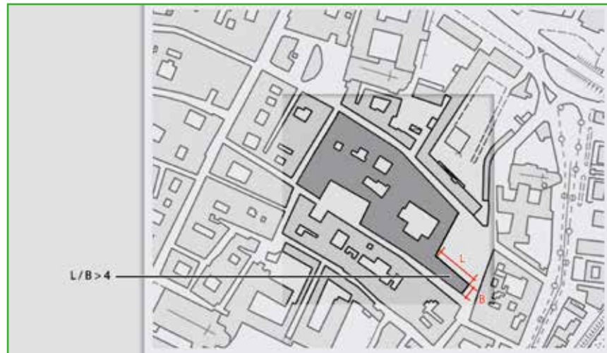
Figura AS 20. Aggregato strutturale con testata snella.
