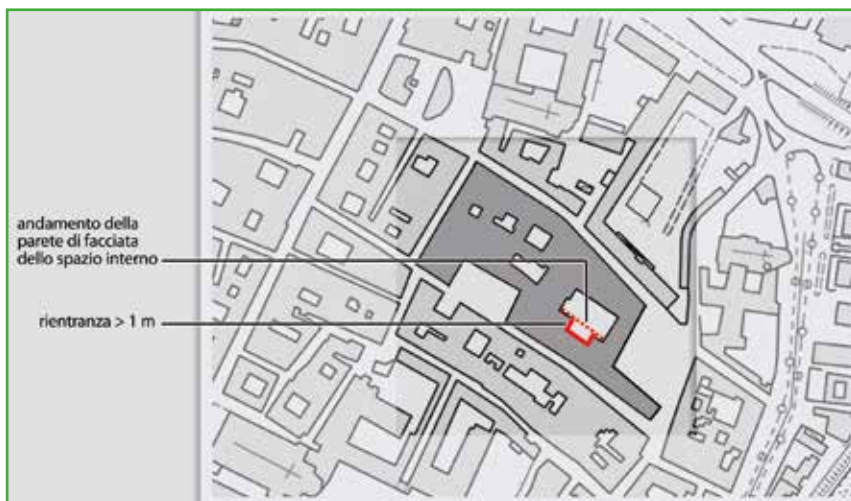
Figura AS 19. Regolarità strutturale - Disallineamento degli spazi interni.
