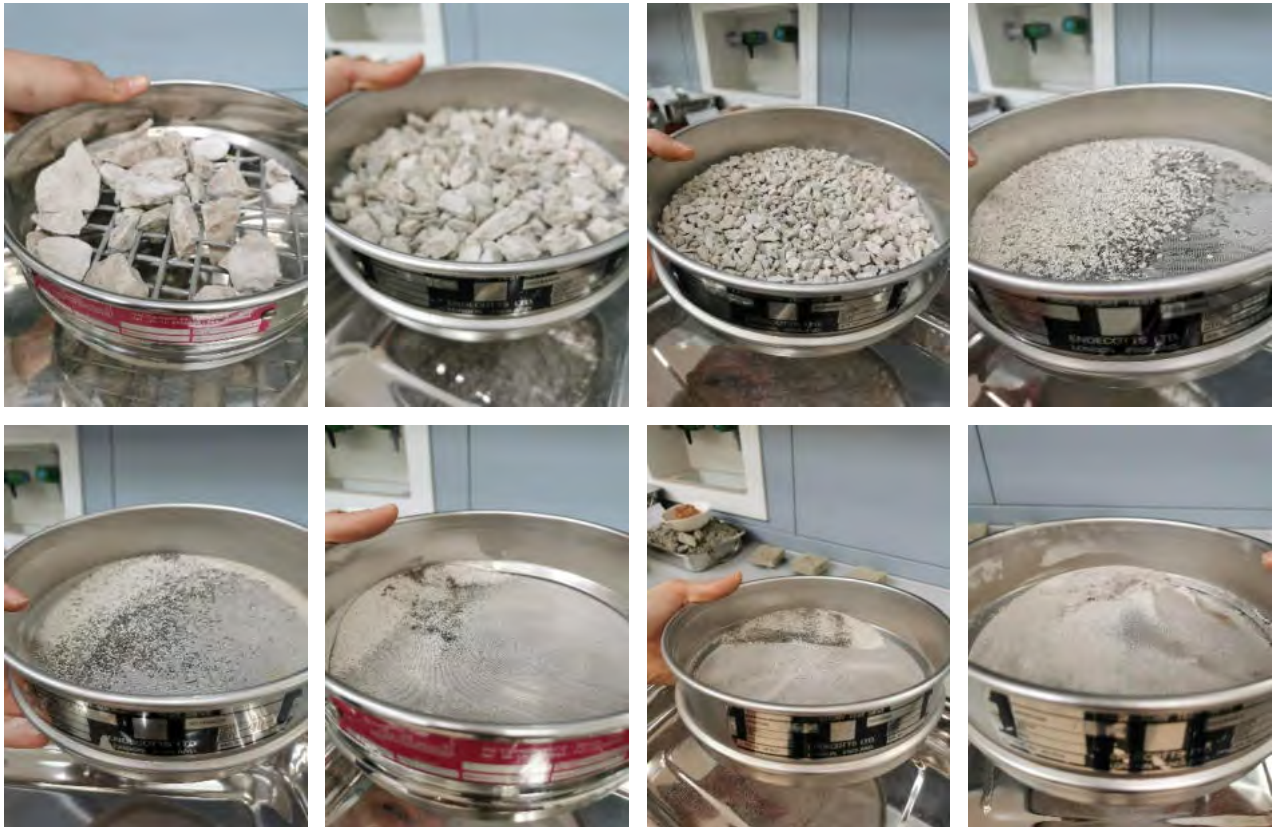
Figura 17 – Materiale di un campione trattenuto dai diversi setacci.
